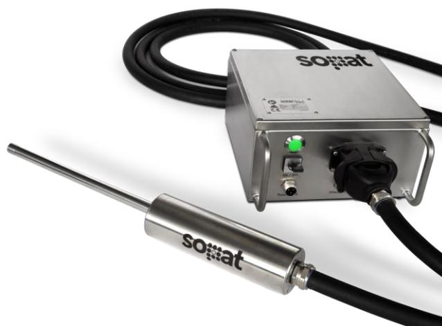
Diese Sonde kann direkt in einen laufenden Prozess eingeführt werden, um mittels Bildanalyse Informationen über Partikelgröße und -form zu erhalten. Die Sonde kann mit einem Kühltubus ausgestattet werden, um den Prozessbereich zu erweitern. Außerdem sind zahlreiche Prozessanschlüsse wie Flansche und Klemmverschraubungen erhältlich.
